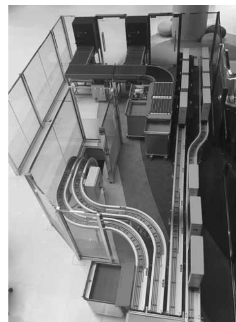
Systém kolejnic pro automatické pojízdné boxy zajišťuje rychlou distribuci knih uživatelům po knihovně
